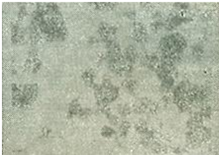
ნახ.3. ახალი ხიბულის ბენტონიტური თიხის სურათი ელექტრონულ მიკროსკოპში.
